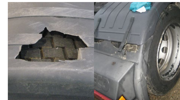
Uklanjanje materijala, slomljen dio
