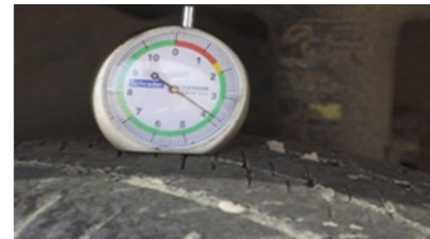
Gume: Baza dubine utora \geq 7 mm Napomena: Istrošenost guma se mjeri u najistrošenijem udubljenju na gumi.
