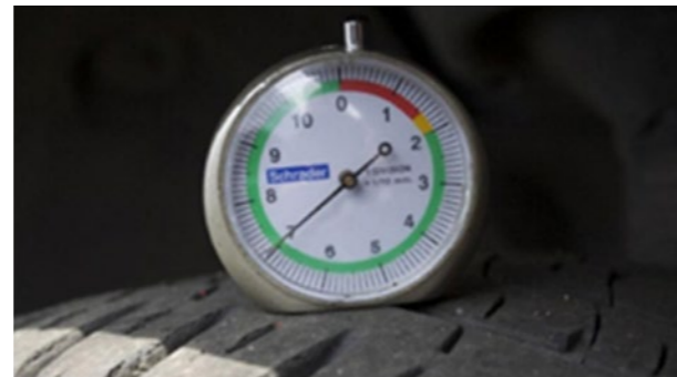
Gume: Baza dubine utora \geq 7 mm (ODGOVARA) Napomena: Istrošenost guma se mjeri u najistrošenijem udubljenju na gumi.
