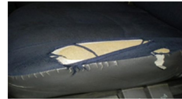
Opekotina > 3 mm, perforacija ili istrošenost prekrivača, bez oštećenja pjene
