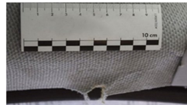
Platnena i plastična obloga: Istrošenost, rupa > 5 mm, neizbrisivi tragovi
