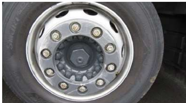
Naplatti i poklopci točkova: Višestruke površine ogrebotine sa ili bez uklanjanja materijala
