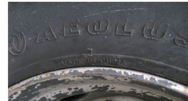
Gume: Baza dubine utora \geq 7 mm Napomena: Istrošenost guma se mjeri u najistrošenijem udubljenju na gumi.
